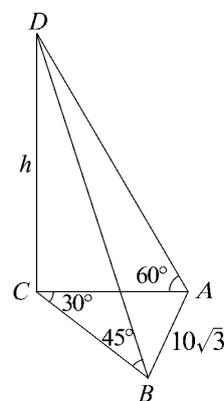
6. 欲測湖岸兩點  $C$ 、 $D$  的距離，在湖外  $A$ 、 $B$  兩點測得  $\overline{AB} = 30$  公尺， $\angle CAB = 120^\circ$ ， $\angle DBA = 135^\circ$ ， $\angle DAB = 30^\circ$ ， $\angle CBA = 45^\circ$ ，則  $\overline{CD} =$ \_\_\_\_\_。
