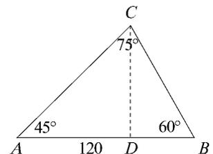
$\triangle ABC$  中，河寬  $\overline{CD} \perp \overline{AB}$ ，故  $\overline{CD} = \frac{\overline{AC}}{\sqrt{2}} = 60\sqrt{3}(\sqrt{6}-\sqrt{2}) \cdot \frac{1}{\sqrt{2}} = 60(3-\sqrt{3})$  公尺
